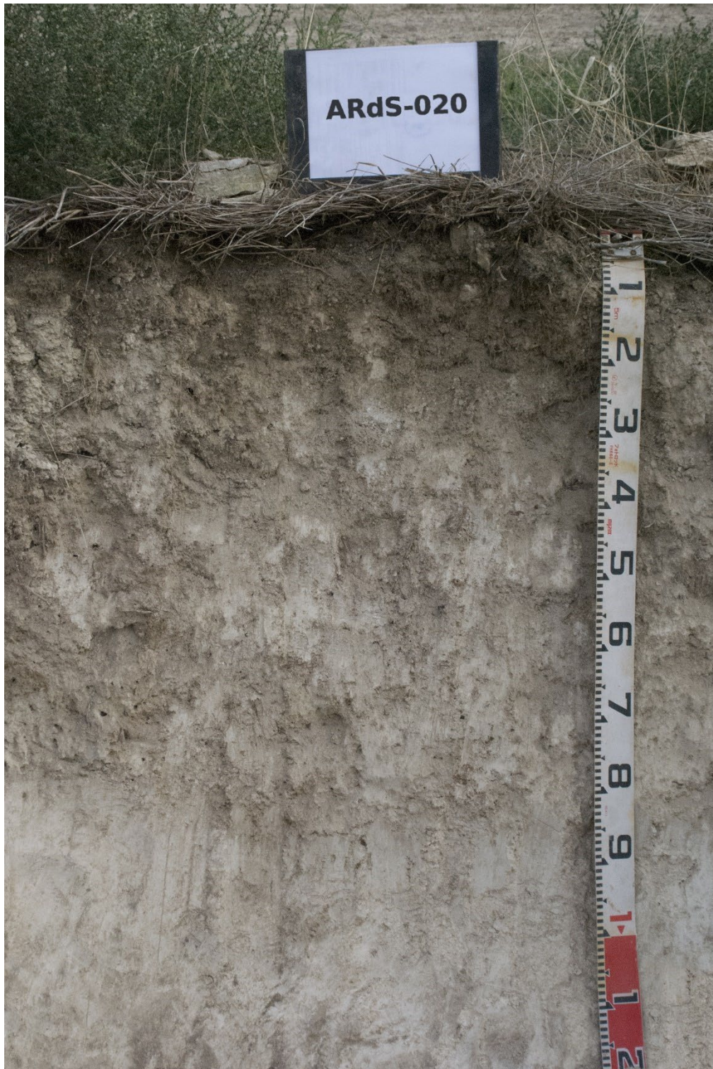
Seqüència d'horitzons: Ap-By1-By2 Cartografia de sòls a escala 1:25.000 del full d'Artesa de Segre (ICGC, 2024).
