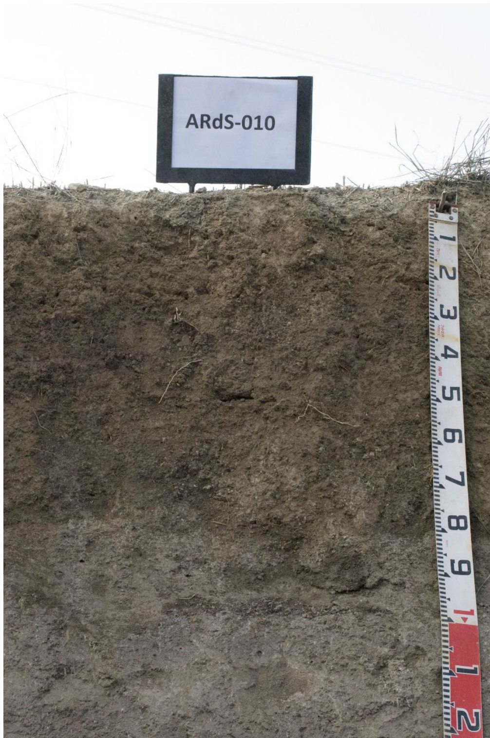
Secuencia de horizontes: Ap-Bwy-By Cartografía de suelos a escala 1:25.000 de la hoja de Artesa de Segre (ICGC, 2024).
