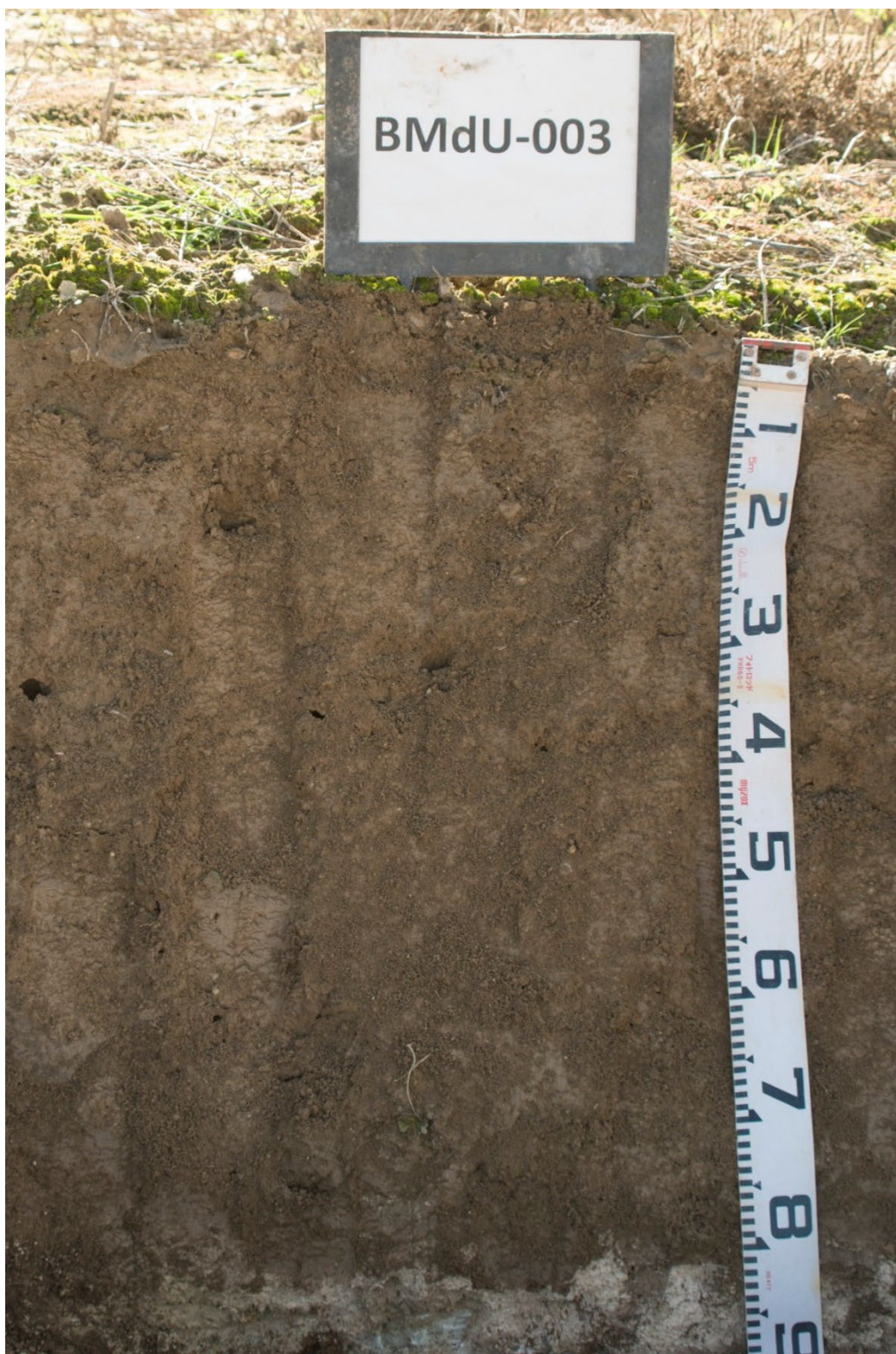
Secuencia de horizontes: Ap-Bw-Cy (yeso) Cartografía de suelos a escala 1:25.000 de la hoja de Bellcaire d'Urgell (ICGC, 2020)
