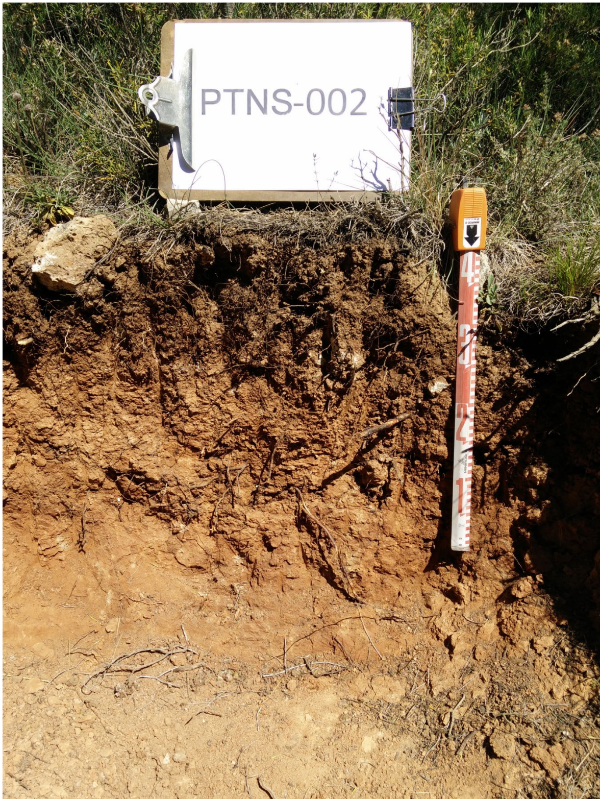
Seqüència d'horitzons: A-B/C-C (lutita/marga) Cartografia de sòls a escala 1:25.000 del full de Sant Martí Sarroca (69-32 / 419-1-2) (ICGC, 2015).
