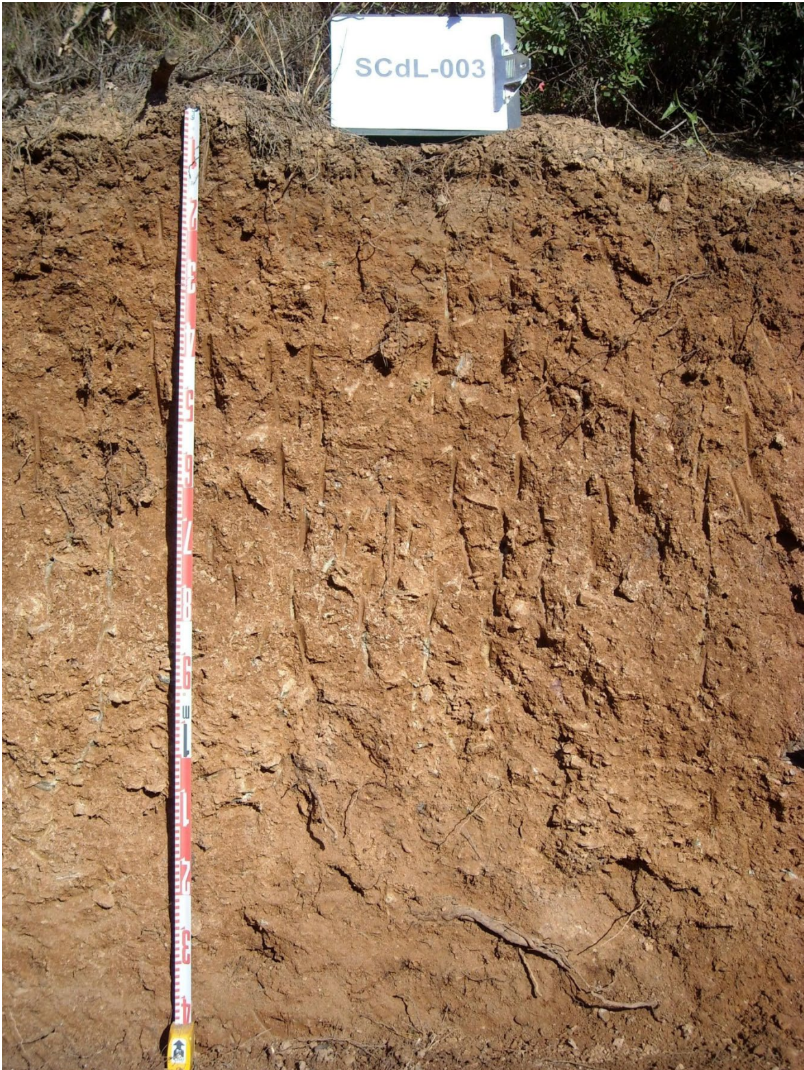
Secuencia de horizontes: A-Bwk1-Bwk2. Cartografía de suelos a escala 1:25.000 de la hoja de Castelldefels-Vallcarca (IGC, 2013)
