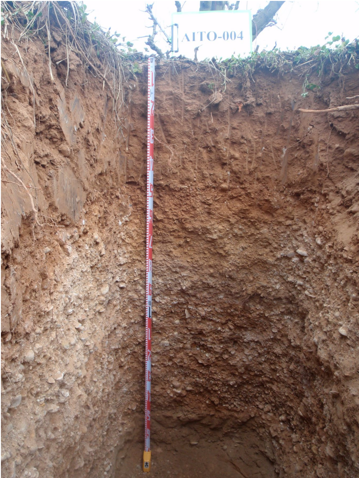
Secuencia de horizontes: Ap1-Ap2-Bk (gravas) Cartografía de suelos a escala 1:25.000 de la hoja de Sarroca de Lleida (IGC, 2010).
